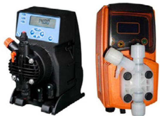
In questo tipo di pompa la variazione di volume è data dall'oscillazione di una membrana che chiude un lato di una camera. Il movimento è solitamente impresso alla membrana per via meccanica, per esempio attraverso un sistema a leva e manovella o una camma, mossi da un motore elettrico o da una azione di tipo magnetico, tipologia utilizzata per il dosaggio dei prodotti chimici in piscina.
