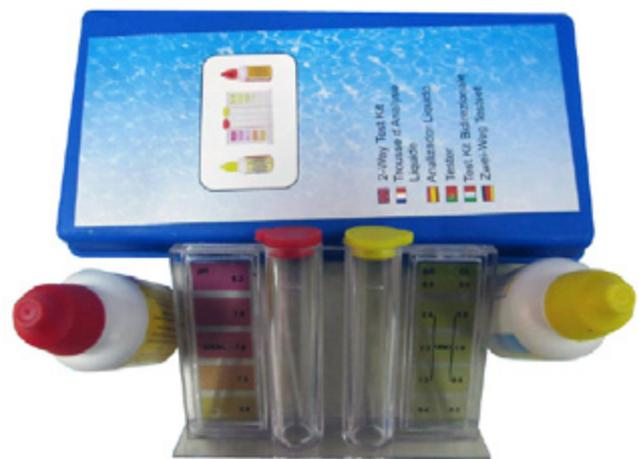
La molecola di **Orto - Tolidina** (OTO) reagisce con il cloro totale con la formazione della caratteristica **colorazione gialla**. Quanto più intensa è la colorazione gialla tanto più alta è la concentrazione di cloro.
